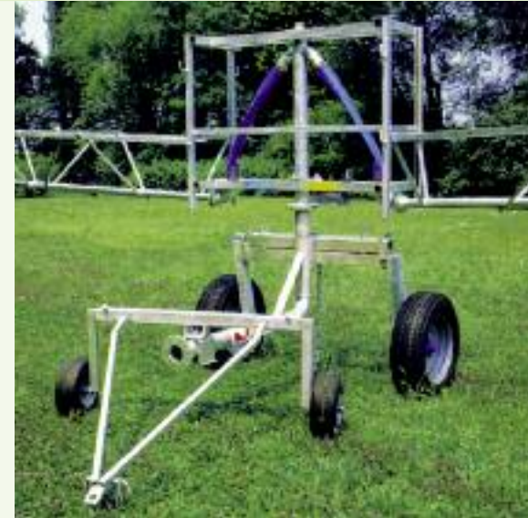
carrello porta ala con doppia ruotina anteriore - chariot porte-rampe avec double roue anteriore - carretilla porta ala con doble rueda anterior - trolley with double front wheel.
